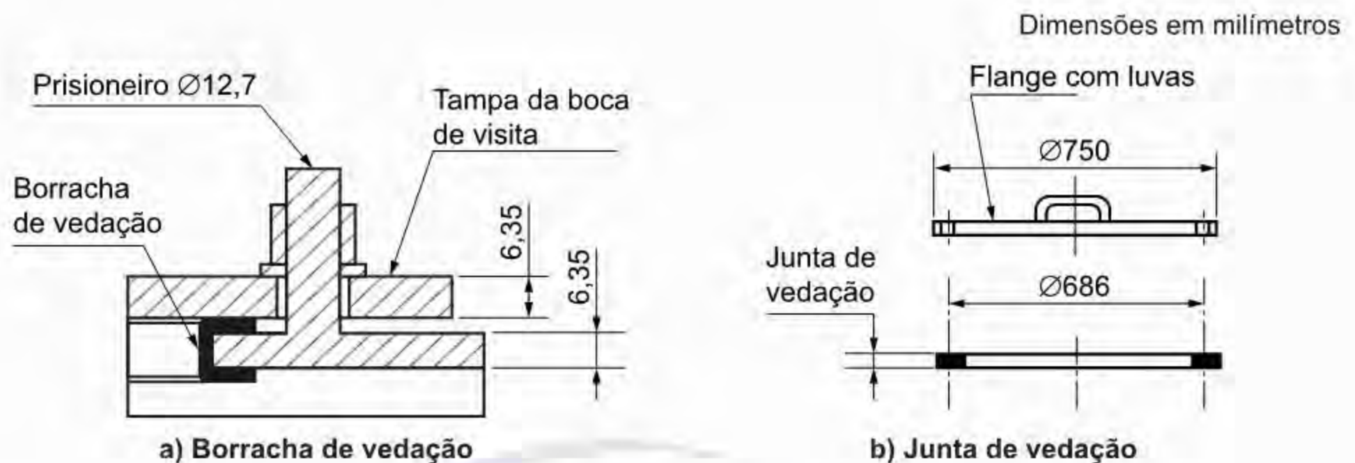
Figura 9 – Vedação da tampa da boca de visita
