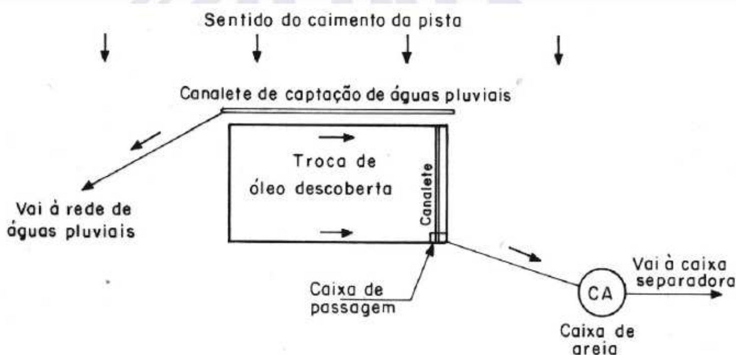
Figura 4 — Troca de óleo em área descoberta
